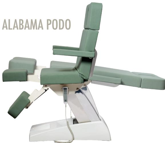
Poltrona Pedicure multifunzione 3 motori per trattamenti viso, corpo e trucco. Regolazione elettrica di altezza, schienale e bascula (trendelenburg). Materasso rivestito in skay, ignifugo e resistente agli oli. Braccioli ribaltabili ed estraibili. Gambale ruotante di 90° all'esterno. Appoggiatesta e appoggiapiedi regolabili ed estraibili. Inclinazione schienale 80°. Foro viso incluso. Struttura in acciaio verniciato e ABS.
